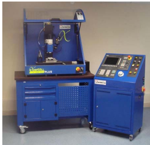
Rys.5.Frezarka szkoleniowa eXpertMill VMC-0600 Plus.
